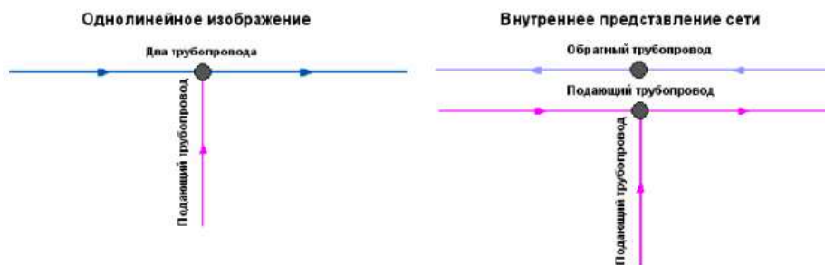
Рис. 3.7. Подключение подающего трубопровода к тепловой сети
